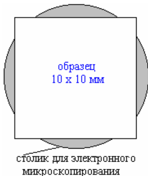
Рис.6 - Портативная импакторная ловушка для изучения образца в сканирующем электронном микроскопе. На поверхность столика наклеена двухсторонняя клейкая лента (Scotch –3М).
