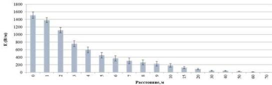
Пример затухания магнитных полей тока промышленной частоты 50 Гц до фоновых значений от линий электропередачи напряжением 110 кВ
