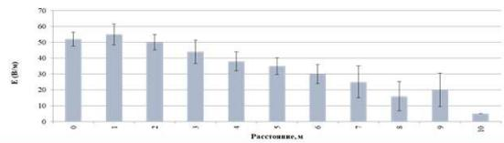
Пример затухания магнитных полей тока промышленной частоты 50 Гц до фоновых значений от линий электропередачи напряжением 10 кВ
