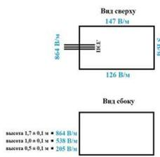
Рис. – Распределение уровней напряженности ЭП тока промышленной частоты 50 Гц электрической подстанции «Петровщина»
