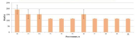
Пример затухания электрических полей тока промышленной частоты 50 Гц до фоновых значений от ВЛ напряжением 110 кВ
