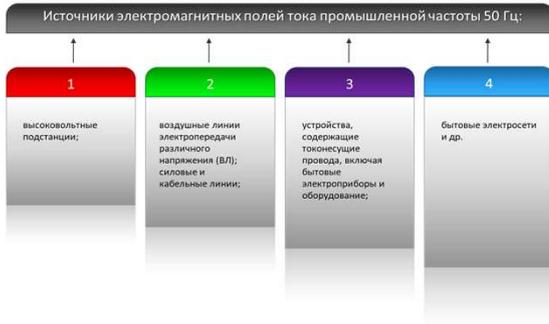
Распространенность источников электромагнитных полей тока промышленной частоты 50 Гц:
