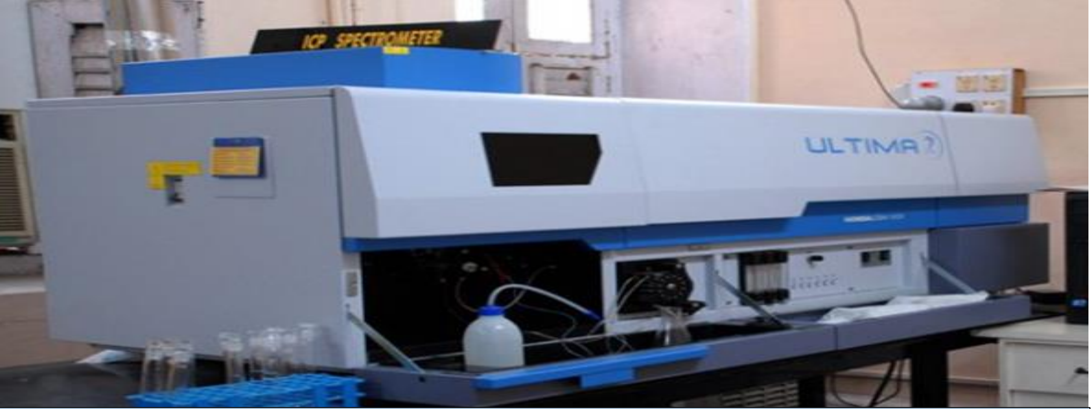
Атомно-эмиссионный спектрометр с индуктивно-связанной плазмой JY 2000-2 (Horiba Yobin Ivon, Франция)
