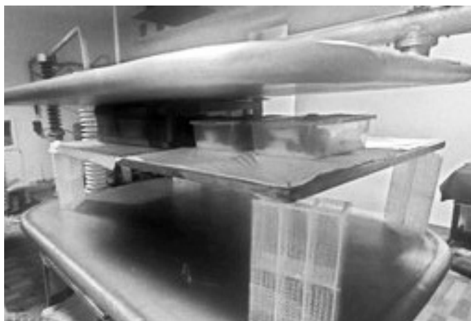
Рисунок 1 – Экспозиция животных внутри высоковольтного стенда электрического поля промышленной частоты
